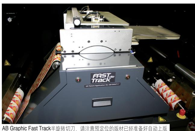
AB Graphic Fast Track半旋转切刀，请注意预定位的版材已经准备好自动上版
