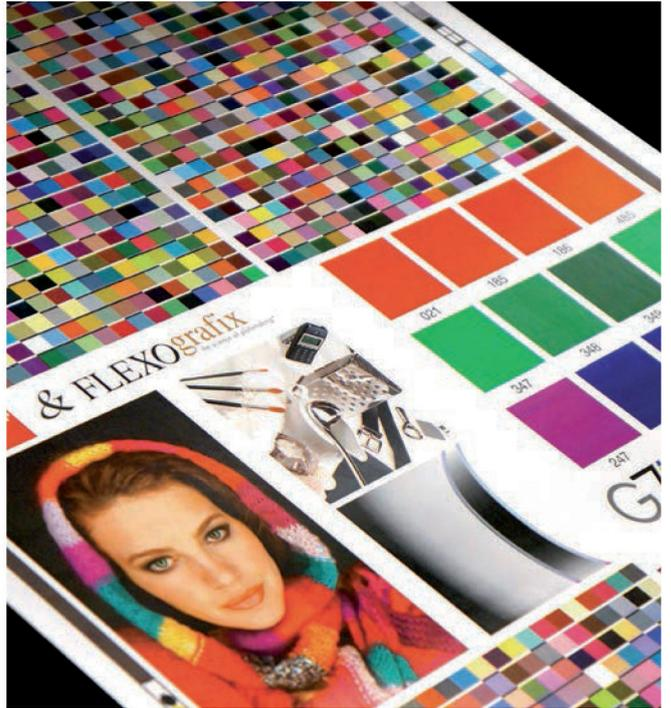
采用一组印版以及试印刷时使用的曲线进行特性化测试
