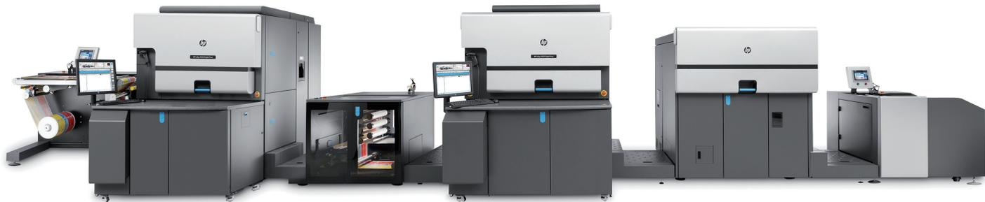
HP Indigo 8000窄幅轮转数字印刷机：（从左至右）分别是进料单元、框架印刷引擎、主从模式的印刷引擎以及连线后加工单元
