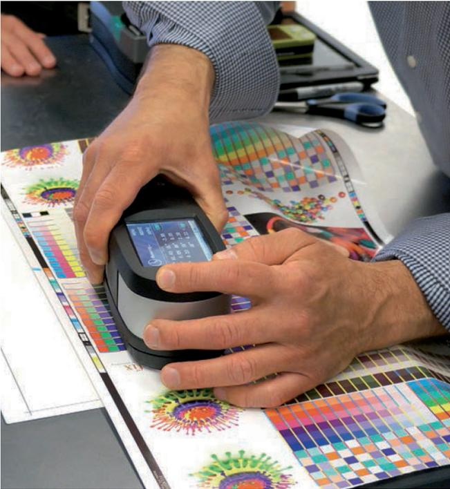
采用分光光度计测试颜色和密度以进行试印刷
