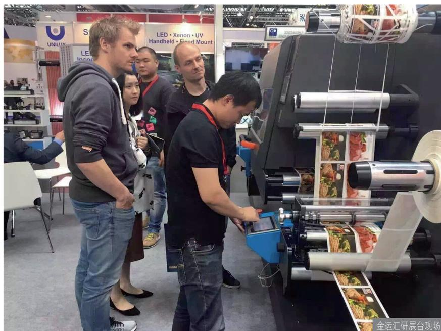
条形码和可变数据校验；还可以检测各种基材，包括全息箔。
